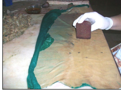
Fotoğraf 23: Derinin tıraş sırasında nemlendirilmesi
