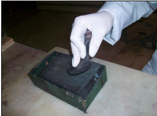
Fotoğraf 20: Bıçkınin Girit taşında bileğilenmesi.
