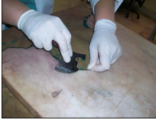
Fotoğraf 18: Bıçkı ve sol el pozisyonu
