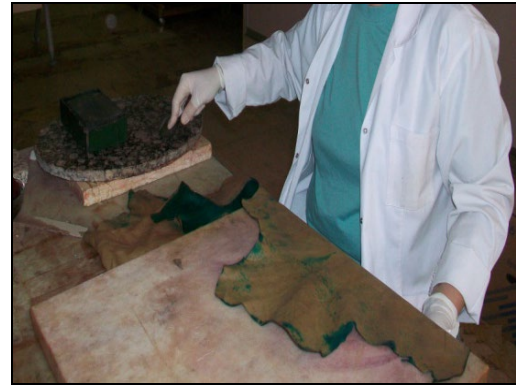
Fotoğraf 17: Derinin mermer üzerine serilmesi
