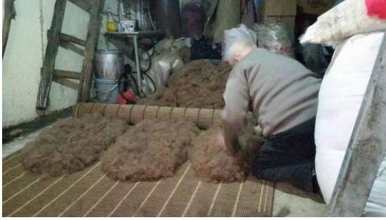
Görsel 24: Afyonkarahisar Kocataş Keçecilik atölyesinde hasıra saçılan yünlerin elle bastırılarak düzeltmesi işlemi (Küçükkurt, 2017; 116).
